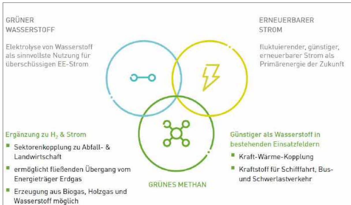
Abbildung 26 | Biomethan als Energieträger, Quelle: (Christian Löffler, 2022)
