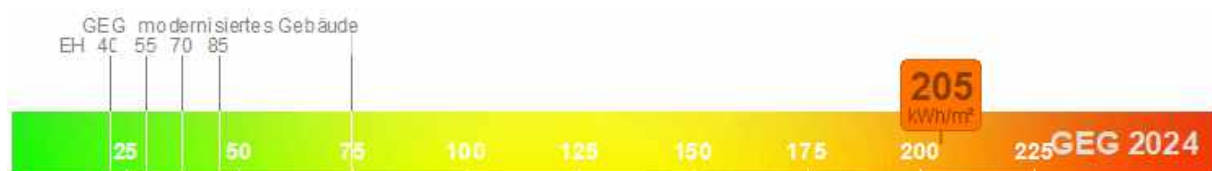
Abbildung 18: Primärenergiebedarf des betrachteten MFH nach DIN V 18599
